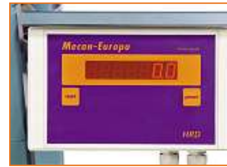
Elektronische Anzeige der Werkstücklänge
