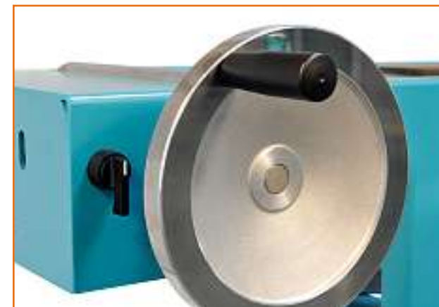
Handrad zum Verfahren des Anschlags mit Schalter zum Betätigen der pneumatischen Klemmung
